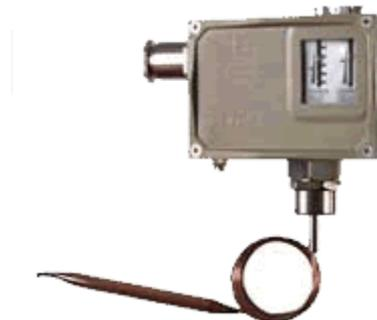
控制器采用带毛细管温包式传感器。可用于流动的中性气体和液体介质，如果介质为腐蚀性，安装时可选用不锈钢温包保护套套在铜质温包外（见附件）。控制器的设定植可调，调节范围 - 30……280℃。
